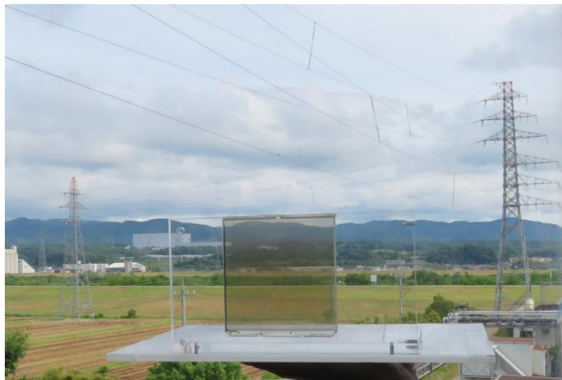
図1 透明な方向可変型液晶メタサーフェス反射板(試作品)
