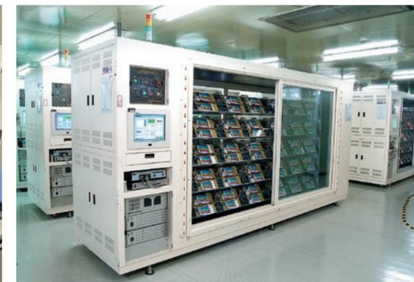
製造工程でのエージング検査
